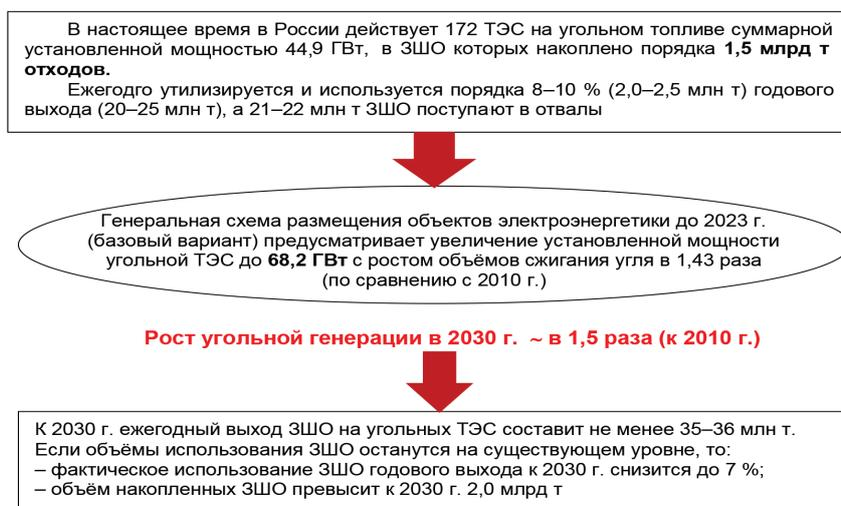
**Рис. 1.** Накопление и использование золошлаковых отходов угольных электростанций: существующее положение и перспективы / **Fig. 1.** Accumulation and use of ASW from coal power plants: current situation and prospects
